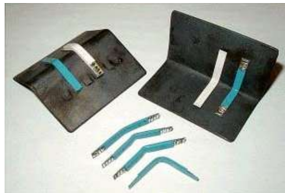
Obr. 2 Ohýbané viacvrstvové moduly na báze LTCC s vonkajšími a vnútornými uhlami ohybu Fig. 2 Bent multilayer modules based on LTCC by external and internal bent angles
