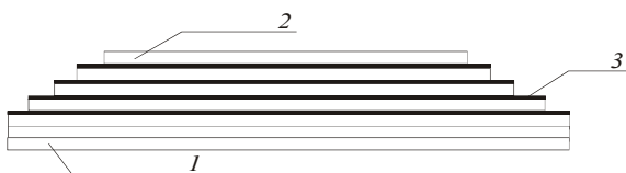
Obr. 1 „Pyramídový tvar“ viacvrstvovej (sedemvrstvovej) štruktúry pred tvarovaním: 1) podložné vrstvy, 2) krycia vrstva, 3) hrubovrstvové vodiče
